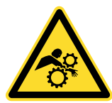
Peligro de atrapamiento
