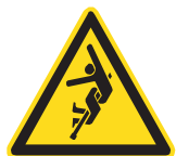
Peligro de atrapamiento - taladradora giratoria
