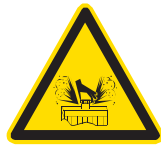
Peligro de salpicaduras de refrigerante caliente
