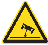
Peligro de caída lateral, desde posición nivelada
