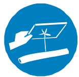
Utilice cartón para localizar las fugas de las mangueras
