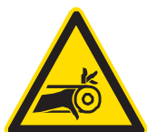
Peligro de atrapamiento
