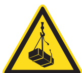
Peligro de cargas suspendidas
