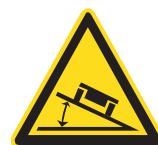
Peligro de vuelco lateral
