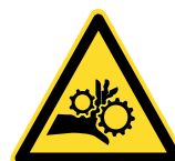
Peligro de atrapamiento
