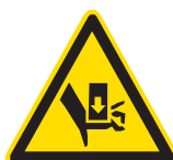
Peligro de aplastamiento de las manos
